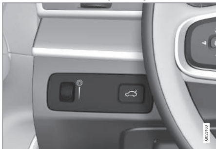
Kolečko (doleva) pro nastavení jasu interiéru.
