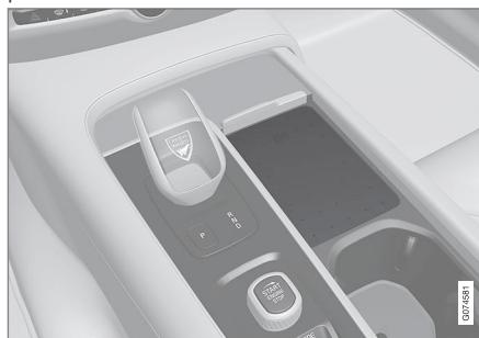
Bezdrátová nabíječka telefonu v tunelové konzole.
