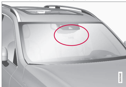
Umiejscowienie modułu radarowego
