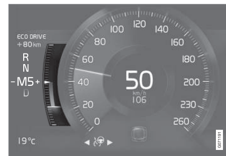
Wskaźnik ECO na 8-calowym wyświetlaczu kierowcy.
