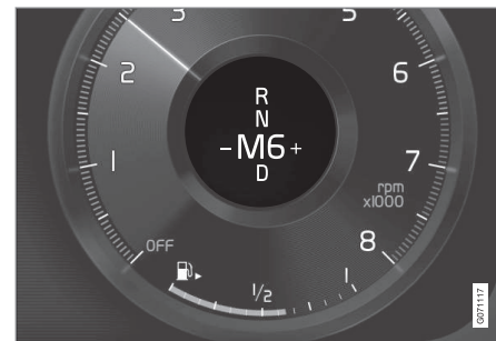
Wskaźnik zmiany biegu na 12-calowym wyświetlaczu kierowcy dla małej dźwigni zmiany biegów*.
