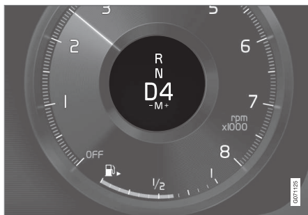
Widok wyświetlacza kierowcy podczas zmiany biegów za pomocą manetek przy kierownicy, mała dźwignia zmiany biegów.
