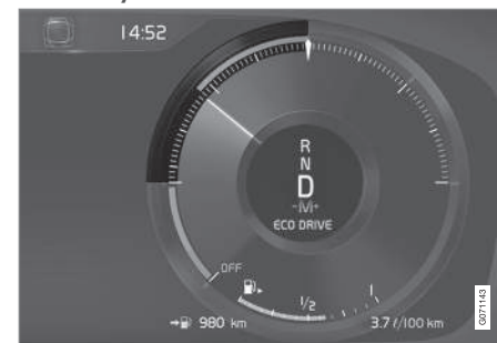
Wskaźnik ECO na 12-calowym wyświetlaczu kierowcy*.
