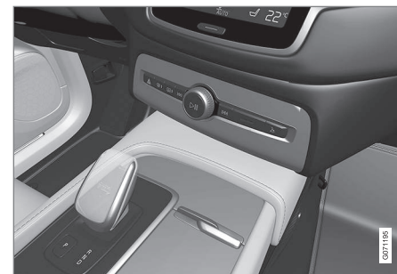
Overzicht kleine schakelhendel wanneer het niet mogelijk is om de schakelblokkering te deactiveren.
