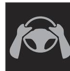
Se Pilot Assist rileva che il conducente non tiene le mani sul volante, il sistema avverte con simbolo e messaggio testuale sul display del conducente per esortare a sterzare attivamente l'automobile.
