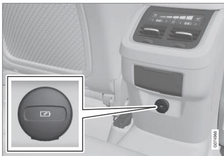
Prese USB (tipo C) sul retro del tunnel per la ricarica, ad esempio, di telefoni e tablet<sup>6</sup>.
