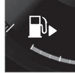
Con una freccia accanto al simbolo del serbatoio, il display del conducente indica il lato dell'automobile in cui si trova lo sportello del serbatoio.
