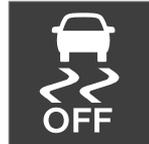
L'attivazione della **Modalità Sport ESC** è segnalata sul display del conducente da questo simbolo, che rimane acceso con luce fissa finché la funzione non è disattivata o fino allo spegnimento del
