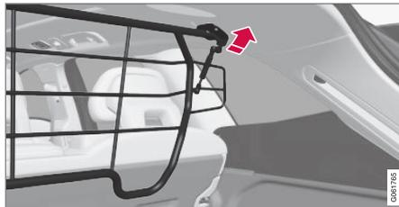
Sistemare i dispositivi di fissaggio della griglia protettiva negli attacchi del padiglione.
