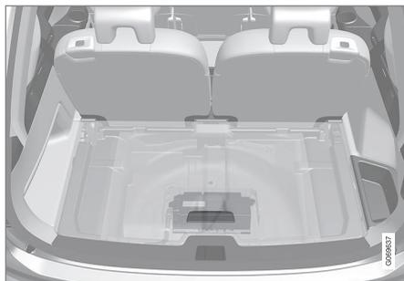
Se l'auto è dotata invece di batteria ausiliaria da 48 V, essa è ubicata sotto il vano di carico. La scatola sopra la batteria ausiliaria da 48 V può essere rimossa solo da un riparatore autorizzato.
