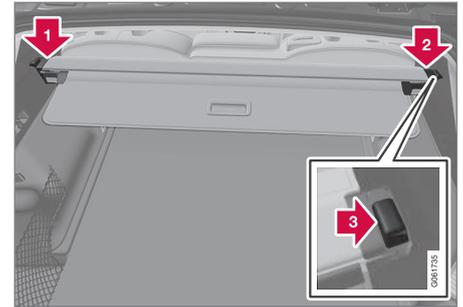
1. Inserire una delle estremità del copribagagliaio nella rientranza nel pannello laterale del bagagliaio.
