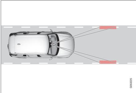
Driver Alert Control rileva la posizione dell'automobile nella corsia di marcia.
