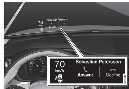
L'Head-Up Display visualizza avvertimenti e informazioni su velocità, funzioni del regolatore elettronico della velocità, navigazione ecc. nel campo visivo del conducente. Sull'Head-Up Display possono essere visualizzate anche indicazioni su segnali stradali e chiamate in arrivo.
