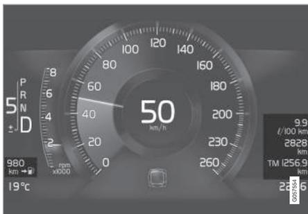
Esempio di informazioni del computer di bordo sul display del conducente da 8 pollici. La figura è schematica - i dettagli possono differire a seconda del modello di automobile.
