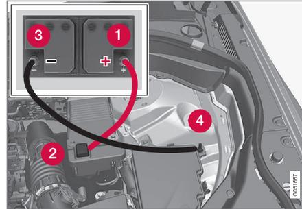
Punti di fissaggio dei cavi di avviamento. L'aspetto del vano motore può variare a seconda di modello di automobile e livello di equipaggiamento.
