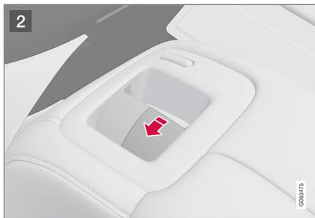
Per le automobili senza ripiegamento elettronico, i poggiatesta esterni si ripiegano manualmente con il comando interno sul lato superiore del sedile, vedere figura 2.
