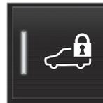
Il pulsante della funzione bloccaggio privato è disponibile nella videata funzioni sul display centrale. A seconda dello stato attuale di bloccaggio viene visualizzato **Serratura sbloccata** o
