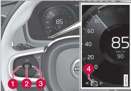
Il limitatore di velocità può essere attivato solo a motore acceso. La velocità max memorizzabile deve essere superiore a 30 km/h (20 mph).
