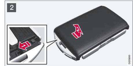
**2** ➔ Capovolgere la chiave telecomando, spostare lateralmente il pulsante e fare scorrere il guscio del lato posteriore verso l'alto di alcuni millimetri.
