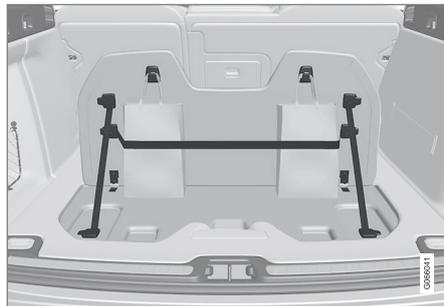
All'interno della copertura, parte integrante della botola del bagagliaio, vi sono due ganci per borse della spesa e una banda elastica<sup>2</sup>. La fascia può essere montata in quattro posizioni.
