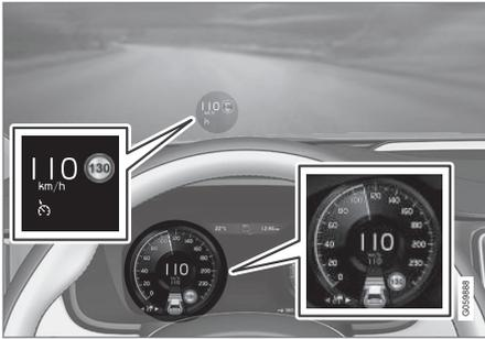
L'immagine precedente mostra che il regolatore elettronico della velocità adattivo è impostato per mantenere una velocità di 110 km/h (68 mph) e che non è presente un veicolo antistante da seguire.
