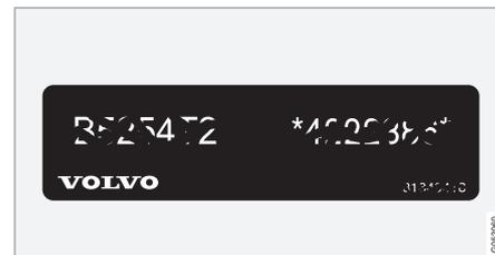
4 Etichetta per codice motore e numero di produzione del motore. Per alcune alternative di motore non c'è un'etichetta; in questi casi, il codice motore inciso può essere invece letto direttamente sul motore.
