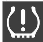
Effettuare i necessari controlli e ripristinare la pressione dei pneumatici quando si accende il simbolo di controllo del sistema e viene visualizzato il messaggio **Bassa press. pneum..**
