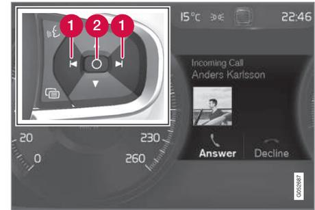
Esempio di messaggio sul display del conducente<sup>5</sup> e comandi destri al volante. La figura è schematica - i dettagli possono differire a seconda del modello di automobile.
