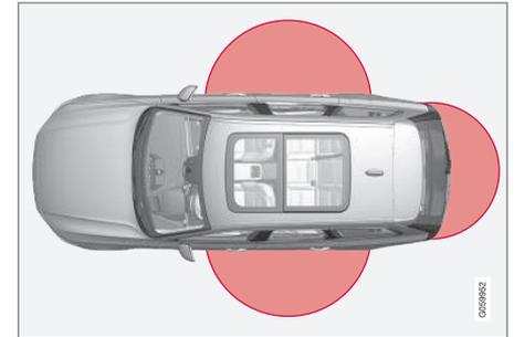
L'area marcata in figura mostra le aree coperte dalle antenne del sistema.
