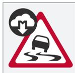
In caso di allarme per fondo stradale scivoloso, viene visualizzato questo simbolo sul display del conducente quando un veicolo si avvicina al tratto scivoloso, sia nella propria automobile che nel
