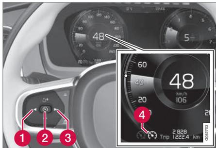
Per avviare il regolatore elettronico della velocità dal modo di attesa è necessario che l'automobile proceda ad almeno 30 km/h (20 mph).
