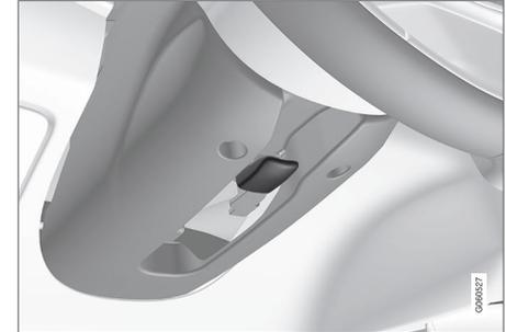
Leva per la regolazione del volante.
