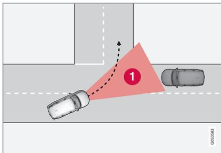
**1** Settore in cui City Safety è in grado di rilevare un veicolo che procede in direzione trasversale opposta.
