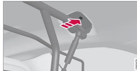
Installare la vite in dotazione e serrarla con la chiave a brugola da 6 mm in dotazione. Ripetere sul lato opposto. Coppia di serraggio raccomandata: 20 Nm (15 ft.lbs).
