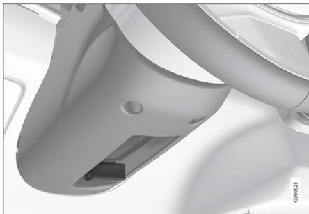
Leva per la regolazione del volante.
