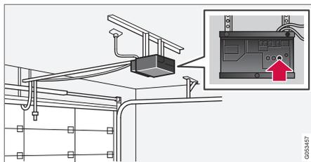
4. Localizzare il pulsante di apprendimento<sup>36</sup> del ricevitore, ad esempio del portone del garage. Solitamente si trova accanto all'attacco dell'antenna sul ricevitore.
