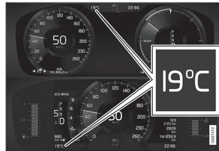
Posizione del termometro della temperatura esterna sui display del conducente da 12" e 8". La figura è schematica - i dettagli possono differire a seconda del modello di automobile.
