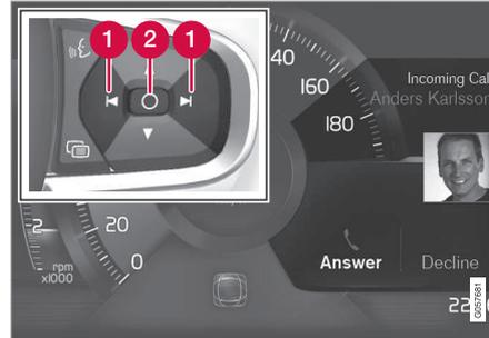
Esempio di messaggio sul display del conducente<sup>4</sup> e comandi destri al volante.
