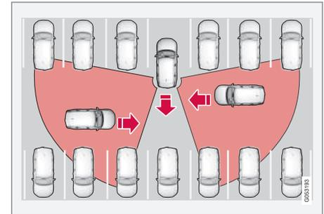
Esempi di aree in cui la funzione Cross Traffic Alert può aiutare il conducente a rilevare gli ostacoli in retromarcia.
