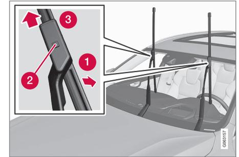
Sollevare il braccio dei tergicristalli quando si trova in posizione di assistenza. La posizione di assistenza si attiva/disattiva dalla videata funzioni sul display centrale ad automobile ferma con i tergicristalli disinseriti.
