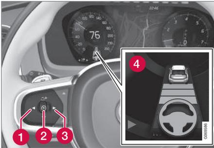
Il volante verde indica che Pilot Assist fornisce ausilio alla sterzata.
