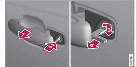
**1**▶ Portare al finecorsa esterno la maniglia della portiera anteriore sinistra, mettendo a nudo la serratura<sup>9</sup>.
