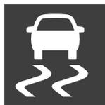
Quando interviene il controllo della stabilità per il traino, lampeggia il simbolo ESC sul display del conducente.
