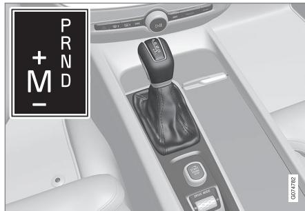
Yleiskuva isosta vaihdevivusta ja vaihtokaaviosta kuljettajan näytössä.
