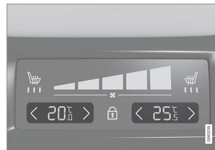
Tunnelkonnoli tagaosa kliimapaneeil olev temperatuuri regulaator.
