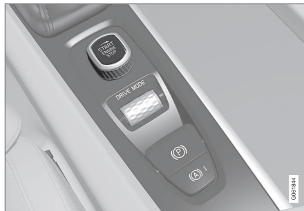
Startknappen i tunnelkonsollen.
