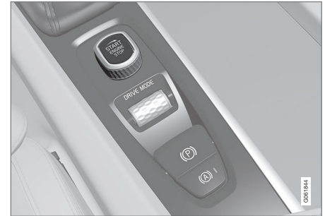
Startvredet i tunnelkonsolen.
