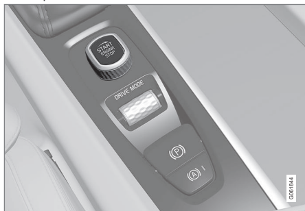
Disco de arranque na consola de túnel.
