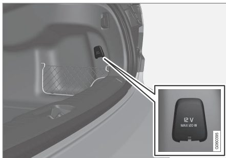
12V-aansluiting in kofferbak/bagageruimte*.
