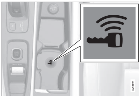
Positie back-uplezer in de tunnelconsole.
