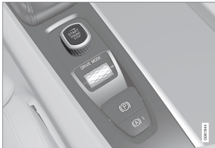
De startknop op de tunnelconsole.
