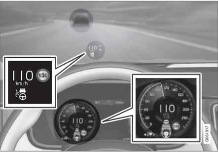
위 그림은 파일럿 보조 시스템(Pilot Assist)이 110 km/h(68 mph)를 유지하도록 설정되어 있는 동시에 동일한 속도로 주행하는 앞차를 따라가고 있음을 보여줍니다.
