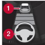
거리 심벌이 스티어링휠 심벌 위에 차량 한대(1)를 표시할 때 파일럿 보조 시스템(Pilot Assist)은 앞차와의 시간 간격만 조절합니다.
