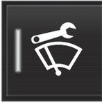
**와이퍼 서비스 위치 버튼을** 누릅니다. 서비스 모드가 활성화되면 버튼의 표시등이 켜집니다. 활성화되면 와이퍼가 서비스 위치로 이동합니다. 서비스 모드를 중지하려면 **와이퍼 서비스 위치 버튼을** 다시 누
