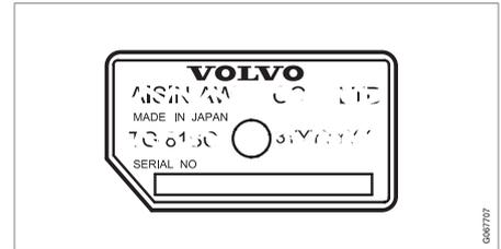
6 변속기 형식 표시 및 일련 번호 스티커.
