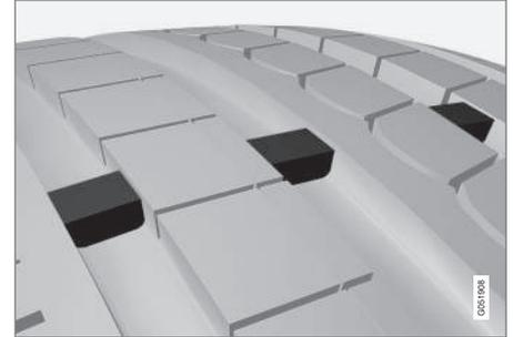
트레드 마모 표지는 타이어의 트레드 패턴의 세로 홈을 따라 있는 좁은 용기부입니다. 타이어 측면에는 TWI (Tread Wear Indicator)라는 글자가 있습니다. 타이어의 트레드 깊이가 1.6 mm(1/16 인치)가 되면, 트레드 높이가 트레드 마모 표지와 동일해집니다. 최대한 빨리 새 타이어로 교환하십시오. 트레드 깊이가 얼마 남지 않은 타이어는 빗길과 눈길에서 매우 낮은 접지력을 제공합니다.
