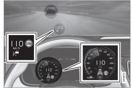
위 그림은 파일럿 보조 시스템(Pilot Assist)이 110 km/h(68 mph)를 유지하도록 설정되어 있는 동시에 동일한 속도로 주행하는 앞차를 따라가고 있음을 보여줍니다.
