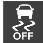
운전자 화면에 **ESC 스포츠 모드** 심벌이 표시되면 기능이 꺼질 때까지 또는 엔진이 꺼질 때까지 이 심벌이 계속 켜진 채로 표시됩니다. 다음에 엔진을 시동하면 시스템이 기본 모드로 돌아갑니다.
