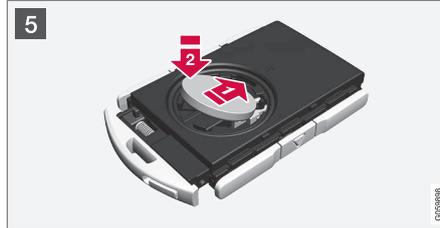
5 새 배터리를 (+) 쪽을 위로 오게 하여 장착합니다. 리모컨의 배터리 접점을 손가락으로 만지지 마십시오.
