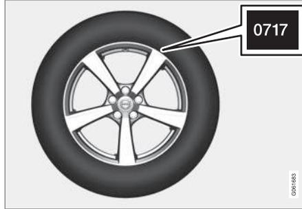
타이어는 부식됩니다. 몇 년이 지나면 경화되기 시작하며 동시에 마찰 용량/특성이 점차적으로 열화됩니다. 이러한 이유로 인해 타이어를 교환할 때에는 가능한 한 새 타이어를 구입하는 것이 좋습니다. 이는 특히 스노 타이어에 해당됩니다. 일련번호의 마지막 4자리는 제조 주 및 연도를 의미합니다. 이는 타이어의 DOT 표시(Department of Transportation)이며 4자리로 표기됩니다(예: 0717). 이 경우에 타이어는 2017년 07번째 주에 제조된 것입니다.
