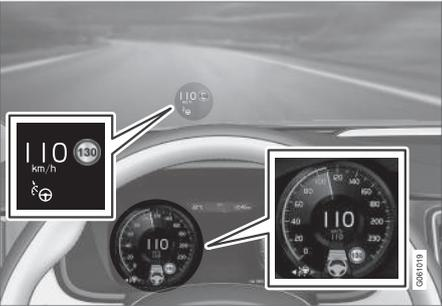
위 그림은 파일럿 보조 시스템(Pilot Assist)이 110 km/h(68 mph)를 유지하도록 설정되어 있고 앞차가 없다는 것을 보여줍니다.
