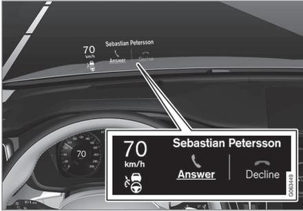
헤드업 디스플레이는 운전자의 시야에 속도, 크루즈 컨트롤 기능, 내비게이션 등과 관련된 경고 및 정보를 표시합니다. 도로 표지 정보 및 걸려오는 전화도 헤드업 디스플레이에 표시할 수 있습니다.
