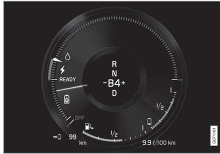
차량이 전류를 생성하여 배터리에 공급하여 배터리가 충전됩니다.(예: 브레이크 페달을 가볍게 밟았을 때 또는 내리막길에서 엔진 브레이크가 작동할 때).
