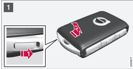
**1** **1** 리모컨을 전방이 보이고 볼보 로고가 음바른 쪽으로 향하게 잡습니다. 키 링 옆의 하단 번부 버튼을 우측으로 밀니다. 앞쪽의 셸을 위쪽으로 몇 밀리미터 움직입니다.
