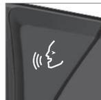
음성 컨트롤 시스템을 통해서 명령을 전달하기 위해서 시스템과 "대화"를 합니다. 시스템을 활성화하고 음성 명령으로 대화를 시작하려면 스티어링 휠의 음성 인식 시스템 버튼
