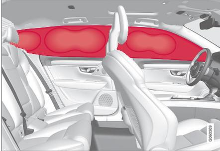
커튼 에어백은 헤드라이닝의 양 측면을 따라 장착되어 있으며 운전자와 차량의 창측 탑승자를 보호하는 데 도움을 줍니다. 패널에 **IC AIRBAG**이라는 라벨이 부착되어 있습니다.
