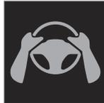
운전자가 스티어링휠을 잡고 있지 않다는 것을 파일럿 보조 시스템(Pilot Assist)이 감지하는 경우에 시스템은 운전자 화면에 심벌과 텍스트 메시지를 통해 경고를 제공하여 운전자가 차량을 능동적으로 조향하도록 요청합니다.
