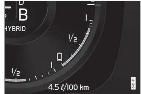
하이브리드 배터리의 에너지는 전기 모터를 구동하는 데에만 사용되는 것이 아니라 차량 냉방 또는 난방에도 사용됩니다. 트립 컴퓨터는 하이브리드 배터리 내에 남은 에너지로 가능한 대략적인 주행 거리를 계산합니다.
