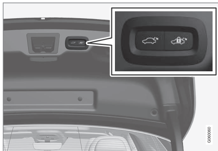
Painikkeen/painikkeiden sijainti tavaratilan luukun alareunassa.
