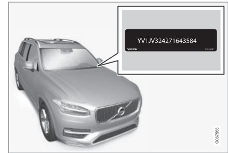
VIN on suunnilleen samassa paikassa kaikissa malleissa.
