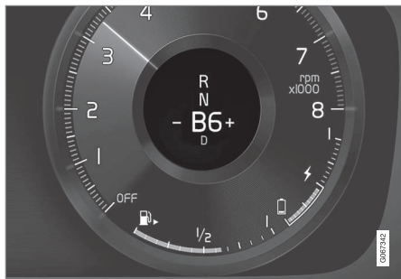
Yleiskuva jarrutustilasta kuljettajan näytössä.
