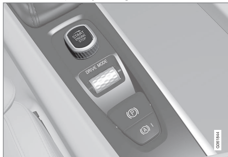
Startknappen i tunnelkonsollen.
