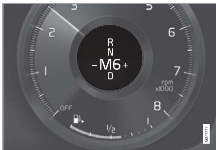
ตัวแสดงการเปลี่ยนเกียร์ในจอแสดงผลสำหรับคนขับขนาด 12 นิ้ว ในรถรุ่นที่ใช้คันเกียร์ขนาดเล็ก*
