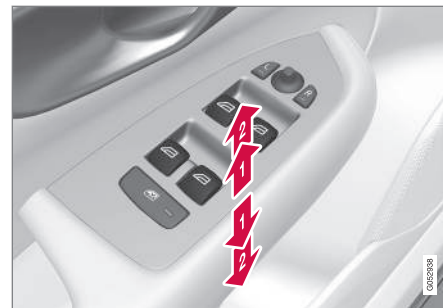
Manövrering av fönsterhissar.
