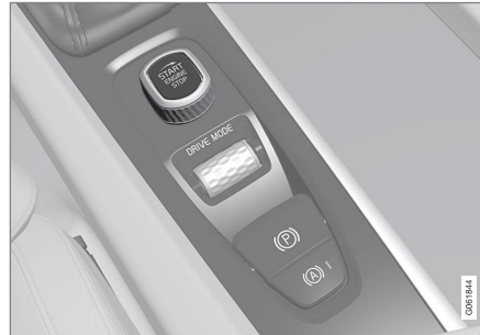
Startvredet i tunnelkonsolen.
