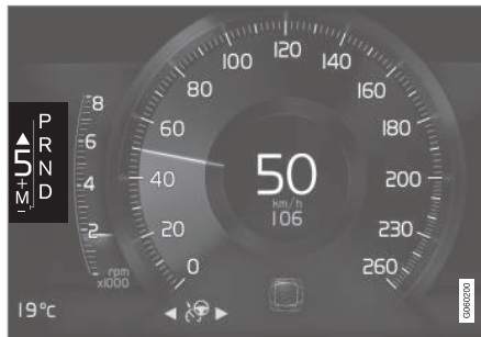
Schakelindicator op 8 inch bestuursdisplay voor de grote schakelhendel.
