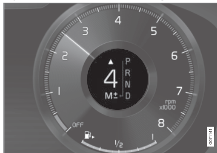
Schakelindicator op 12 inch bestuursdisplay voor de grote schakelhendel*.
