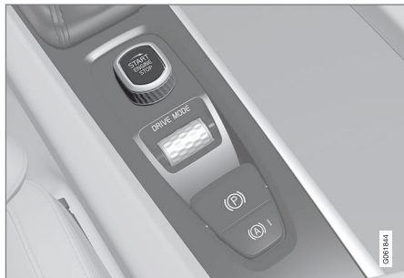
Interruttore di avviamento nel tunnel.
