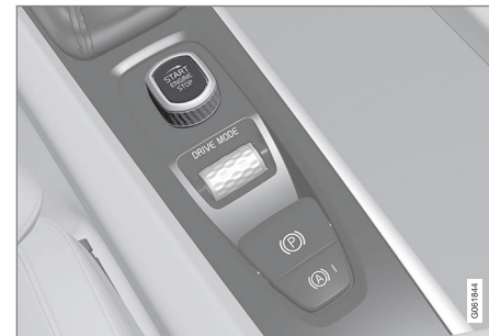
Interruttore di avviamento nel tunnel.
