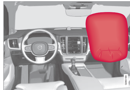
Airbag nel sedile anteriore sul lato passeggero.
