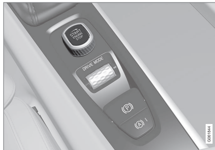
Interruttore di avviamento nel tunnel.
