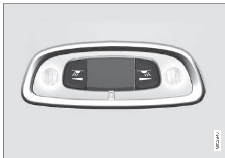
Luci di lettura sopra il sedile posteriore.
