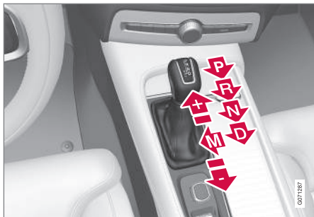
Panoramica della leva selettore grande e delle posizioni del cambio.
