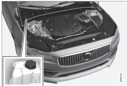
Depósito de expansión del sistema de refrigeración,
