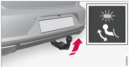
> El enganche para remolque se despliega sin quedar bloqueado. La luz de indicación destella con luz naranja. El enganche para remolque está listo para continuar hasta la posición bloqueada.
