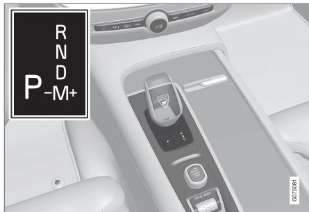
Visión general de palanca de cambios pequeña y patrón de cambios en la pantalla del conductor.
