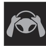
Si Pilot Assist detecta que el conductor no tiene las manos en el volante, el sistema avisa con un símbolo y un mensaje de texto en la pantalla del conductor para instar al conductor a que maniobre activamente el volante del automóvil.
