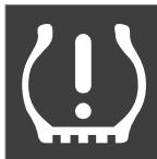
Compruebe y corrija la presión de los neumáticos si se enciende el símbolo de control del sistema y aparece el mensaje **Presión baja neumá..**
