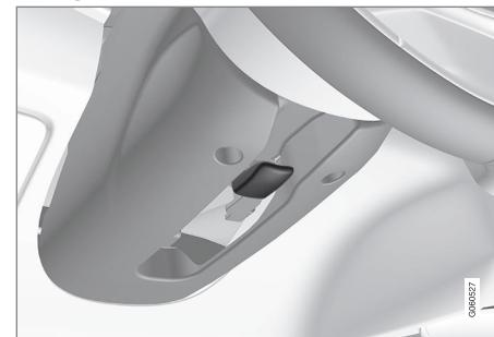
Palanca de regulación del volante.
