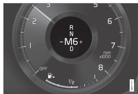
Visión general del patrón de cambios en la pantalla del conductor para la palanca de cambios pequeña.
