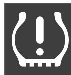
Este símbolo se enciende para indicar presión baja de inflado. Entonces, compruebe la presión de neumáticos en la aplicación **Estado del coche**, en la pantalla central.
