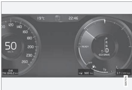
Ejemplo de información del ordenador de a bordo en la pantalla del conductor de 12''. La imagen es esquemática. Los detalles pueden variar según el modelo de automóvil.
