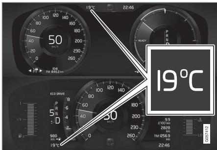
Ubicación del indicador de temperatura ambiente en las pantallas del conductor de 12<sup>1/2</sup>" y 8<sup>1/2</sup>". La imagen es esquemática. Los detalles pueden variar según el modelo de automóvil.
