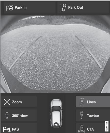
posición del volante. Esto puede facilitar el aparcamiento en línea, la marcha atrás en lugares con poco espacio y el acoplamiento de un remolque.
