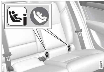
La ubicación de los puntos de fijación se indica con símbolos<sup>2</sup> en el tapizado del respaldo.
