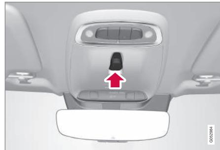
El techo solar se acciona con un mando que está situado en el techo. El mando se activa cuando el sistema eléctrico del vehículo está en la posición de encendido I o II.
