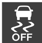
Para indicar que el **ESC Modo deportivo** está activado, en la pantalla del conductor se enciende este símbolo con luz fija hasta que se desactiva la función o hasta que se apaga el motor. La siguiente vez en la que se arranca de nuevo el motor, el sistema vuelve a su modo normal.
