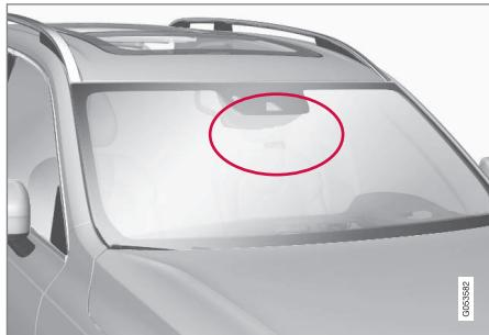
La zona señalada debe limpiarse con regularidad y no debe tener colocados adhesivos, objetos, películas antisolares, etc.
