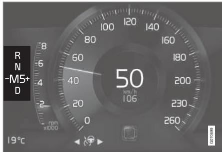
Indicador de cambio de marcha en pantalla del conductor de 8" con palanca de cambios pequeña.
