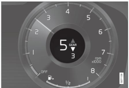
Indicador de cambio en la pantalla de conductor de 12".\*
