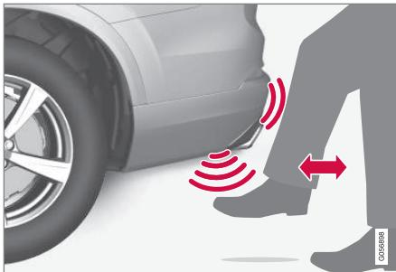
Movimiento con el pie en la zona de activación del sensor.
