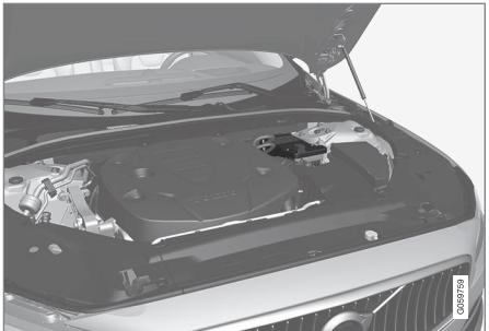
La batería de apoyo de 12 V está situada en una caja al lado del amortiguador vertical.
