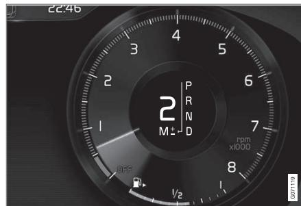
Visión general del patrón de cambios en la pantalla del conductor para la palanca de cambios grande.
