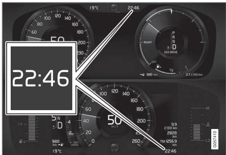
Ubicación del reloj en las pantallas del conductor de 12<sup>\*\*</sup> y de 8<sup>\*\*</sup>. La imagen es esquemática. Los detalles pueden variar según el modelo de automóvil.
