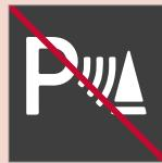
Preste particular atención al conducir marcha atrás cuando se muestre este símbolo en el acoplamiento y conexión eléctrica al automóvil de un remolque, un portabicicletas o similar.
