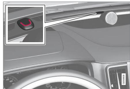
El tablero de instrumentos tiene un diodo luminoso rojo que indica el estatus del sistema de alarma:
