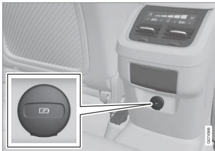
Puertos USB (tipo C) en la parte trasera de la consola del túnel para cargar, por ejemplo, teléfonos y tablets<sup>6</sup>.
