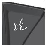
Para dar órdenes mediante comandos a través del sistema de control por voz, se establece un "diálogo" con el sistema. Pulse el botón del control por voz en el volante para activar el sistema e iniciar un diálogo con comandos orales. Después de pulsar el botón se escucha un pitido y en la pantalla del conductor aparece el símbolo del control por voz.
