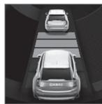
Cuando el símbolo de distancia de separación muestra dos vehículos, el control de velocidad constante adaptativo está regulando el intervalo de tiempo respecto al vehículo que circula delante.
