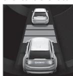
El conductor puede seleccionar diferentes intervalos de tiempo que se indican en la pantalla del conductor en forma de 1 a 5 rayas horizontales. Cuanto más rayas, mayor es el intervalo de tiempo. Una raya equivale a una distancia de seguridad de aproximadamente 1 segundo, 5 rayas equivalen a 3 segundos.
