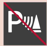
Preste particular atención al conducir marcha atrás cuando se muestre este símbolo en el acoplamiento y conexión eléctrica al automóvil de un remolque, un portabicicletas o similar.
