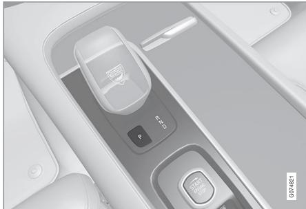
Vista general de la palanca de cambios y la posición P de la palanca de cambios pequeña.
