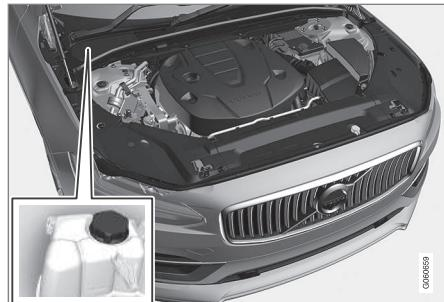
Depósito de expansión del sistema de refrigeración,
