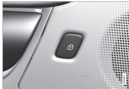
Knap til låsning i bagdør med indikeringslampe.
