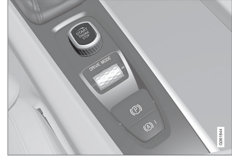
Tünel konsolundaki çalıştırma düğmesi.
