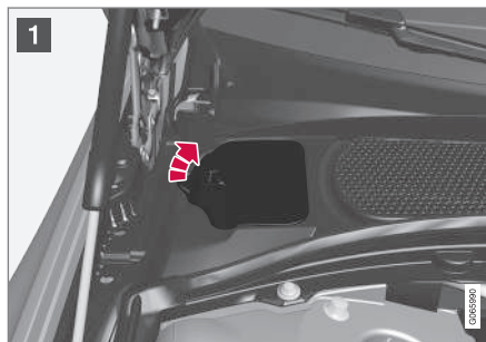
Expansiereservoir voor koelsysteem
