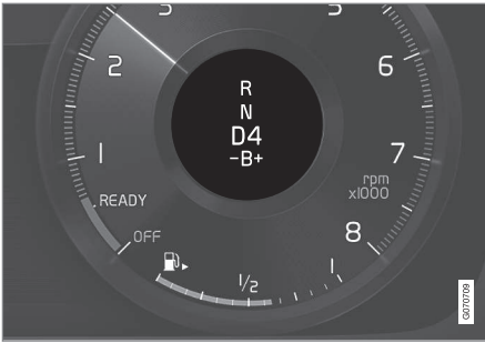
Bestuurdersdisplay bij het schakelen met de stuurpaddles.
