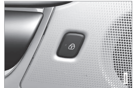
Knop voor vergrendelen in achterportier met led.
