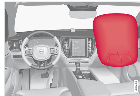
Airbag voor de voorstoel aan passagierszijde.
