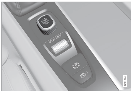
Interruttore di avviamento nel tunnel.
