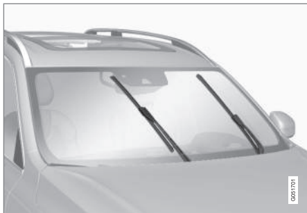
Spazzole tergicristallo in posizione di assistenza.
