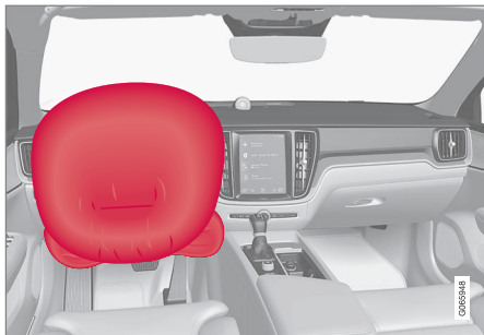
Rat-airbag og knæ-airbag 1 til forsædet i førersiden.
