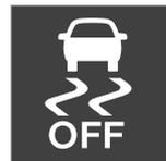
駕駛人顯示器上會以此恆亮符號顯示 ESC 運動模式啟用，直到此功能停用或引擎關閉為止。引擎下次起動後，系統會再度回到正常模式。
