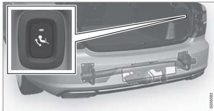
打開行李廂蓋。用以伸/縮拖車桿的按鈕位於行李廂後面右側。按鈕內的指示燈必須恆亮橘光，才可以啟動延伸功能。
