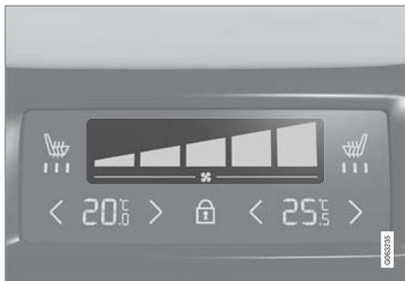
前座中央扶手後方恆溫控制面板上的風扇控制裝置。
