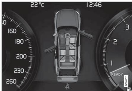
駕駛人顯示器中的圖形代表各種警示訊息。車門及行李廂蓋上的警示顏色會隨著車速變化。
