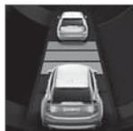
與前車之間有五種不同時間間隔可供選擇，駕駛人顯示器也會顯示出 1-5 條水平線 - 線條越多則其時間間隔越長。一條線相當於與前車相距約 1 秒，5 條線代表約 3 秒。
