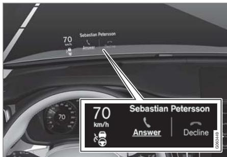
平視顯示裝置會在駕駛人的視野中顯示警告訊息及有關速度、定速巡航控制功能、導航等的資訊。抬頭顯示器也能顯示道路標誌資訊及來電通知。
