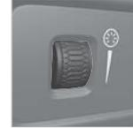
方向盤左側的儀錶板上的撥轉輪用於調整顯示器照明、控制照明、環境裝飾照明及氣氛燈\*的亮度
