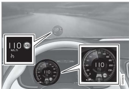
上圖顯示 Pilot Assist 設定為保持 110 km/h(68 mph)，而且沒有前車可跟隨。
