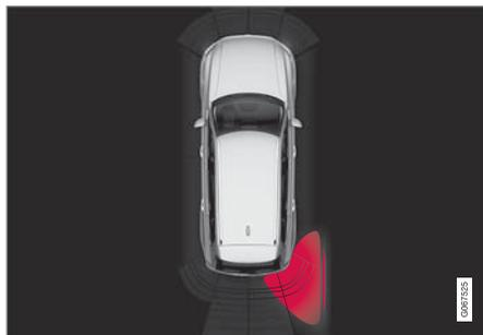
螢幕上的泊車輔助系統圖形亮起 Cross Traffic Alert 圖標。
