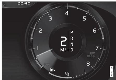
大型排檔桿的駕駛人顯示器中的換檔模式概覽。
