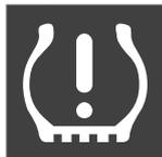
當系統指示燈號亮起，且胎壓過低訊息顯示時，請檢查並矯正胎壓。
