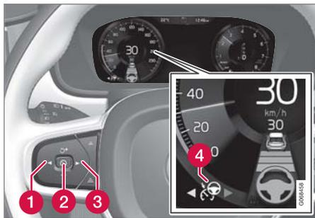
綠色方向盤表示 Pilot Assist 正在提供轉向輔助。
