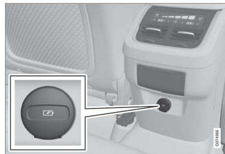
中央扶手控制台後方配備可對手機和平板電腦等裝置充電的 USB 輸入 (C 型)<sup>6</sup>。
