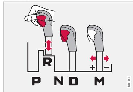
配備大型排檔桿的汽車之排檔桿抑制器。
