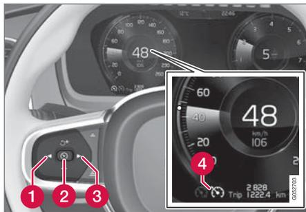
若要從待機模式開始使用定速巡航控制，目前車速必須達到時速 30 公里(20 mph)以上。
