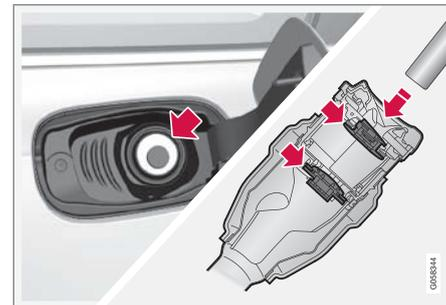
開始為車輛加油之前，務必將泵浦噴嘴插入加油管的兩個可打開的蓋蓋。
