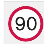
當超過適用的最大許可速度時，駕駛人顯示器中會以閃爍符號<sup>18</sup>顯示該速度的方式發出車速警示。
