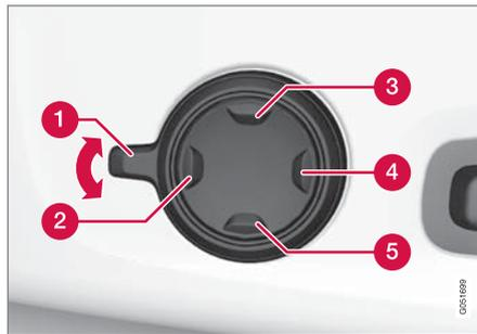
1. 上／下轉動控制器**1**即可啟動多功能控制裝置。此時中央顯示器會顯示座椅設定畫面。
