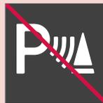
若車輛加掛拖車、自行車架或類似裝備，且拖車與車輛電性連接，則在倒車時看見此符號顯示必須特別留意。
