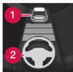
只有當距離符號在方向盤燈號上方顯示一輛車(1)時，Pilot Assist 才會調節與前車的時間間隔。
