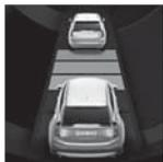
只有當距離符號顯示兩車時，主動式定速巡航控制才會調整與前車的時間間隔。在此同時，系統會標出一段速度範圍。
