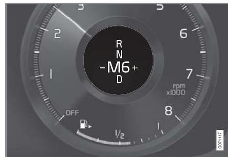
小型排檔桿的駕駛人顯示器中的換檔模式概覽。
