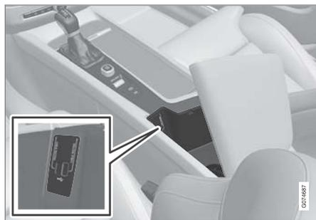
中央扶手控制台內的 USB 輸入 (A 型)。請將連接線向前拉，以免在蓋子關閉時夾到線。
