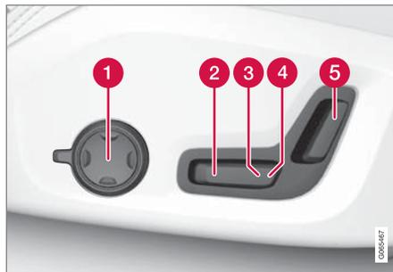
附圖顯示配備四向腰部支撐墊\*的車輛上的控制裝置。配備雙向腰部支撐墊\*的車輛沒有旋轉式多功能控制器。
