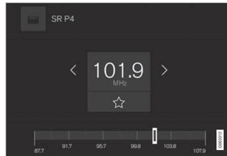
手動搜尋可以尋找和調整到不在該區域自動彙編訊號最強電台清單中的電台。
