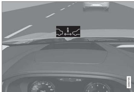
配備有抬頭顯示器的擋風玻璃上的距離警告符號。
