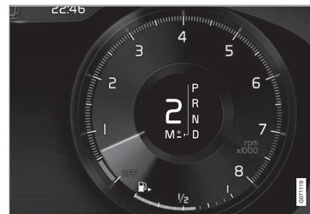
駕駛人顯示器當於手排模式下以大型排檔桿方向盤撥片換檔時。
