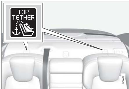
後座後方的置物架上設有指示固定點位置的符號。
