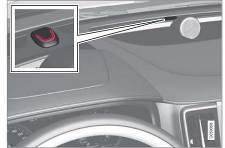
儀錶板上有紅色的 LED 指示燈指示警報系統狀態：
