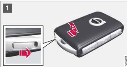
1 握住遙控鑰匙，露出正面，使 Volvo 標誌面對右側。將底緣處鑰匙圈旁的操作鈕滑向右邊。將前側殼體向上滑動幾公釐。
