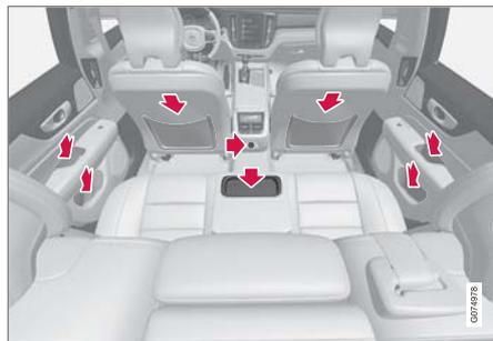
車門板內儲格、中間座位椅背杯架\*、前座椅背儲物袋\*和中央扶手控制台上 USB 埠。
