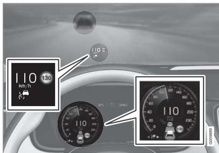
上圖顯示主動式定速巡航控制設定為保持時速 110 公里 (68 mph)，同時跟隨保持相同速度的前車。
