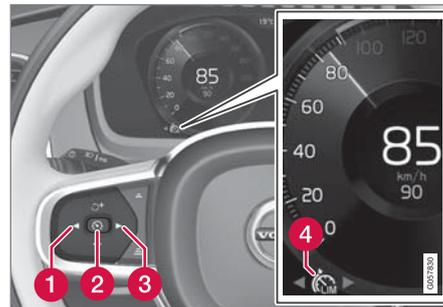
速度限制器必須等到引擎發動後才能啟用。可儲存的最低速度上限為時速 30 公里 (20 mph)。
