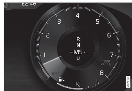
駕駛人顯示器當於手排模式下以小型排檔桿方向盤撥片換檔時。
