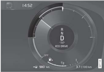
เกจวัด Eco บนจอแสดงผลสำหรับคนขับขนาด 12 นิ้ว*
