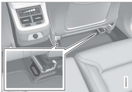
ตำแหน่งของจุดยึดบนที่นั่งด้านหลัง
