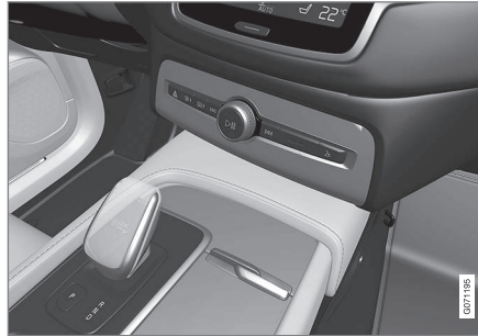
Översikt över liten växelspak där det inte är möjligt att deaktivera växelväljarspärren.
