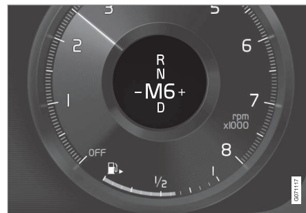
Indicatorul de schimbare a treptei de viteză din afișajul pentru șofer de 12 în la o treaptă de viteză inferioară*.
