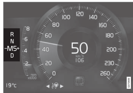
Indicatorul de schimbare a treptei de viteză din afișajul pentru șofer de 8 în la o treaptă de viteză inferioară.
