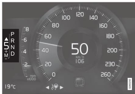
Indicatorul de schimbare a treptei de viteză din afișajul pentru șofer de 8 în la o treaptă de viteză superioară.
