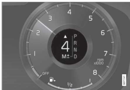
Indicatorul de schimbare a treptei de viteză din afișajul pentru șofer de 12 în la o treaptă de viteză superioară*.
