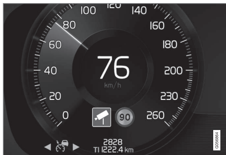
Exemplo de informação sobre câmara de velocidade e limitação de velocidade no mostrador do condutor
