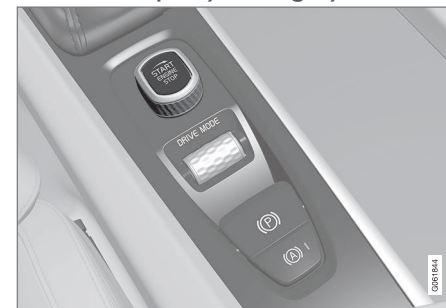
Disco de arranque na consola de túnel.
