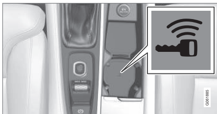
Localização do leitor no console de túnel.
