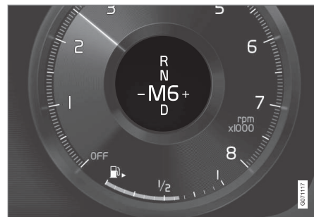
Indicador de mudança de marchas no visor do motorista de 12 polegadas para a alavanca pequena de marchas*.
