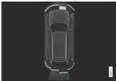
Beeldscherm met obstakelzones en sensorsegmenten.
