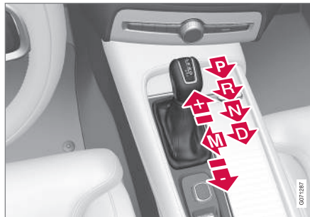
Overzicht grote schakelhendel en schakelstanden.
