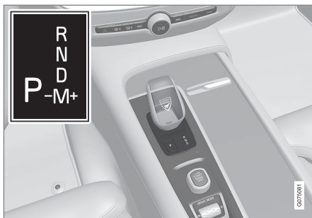
Overzicht voor de kleine schakelhendel en het schakelpatroon op bestuursdisplay.
