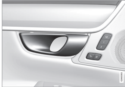
Openingsgreep voor alternatieve ontgrendeling op zijportier 10 .
