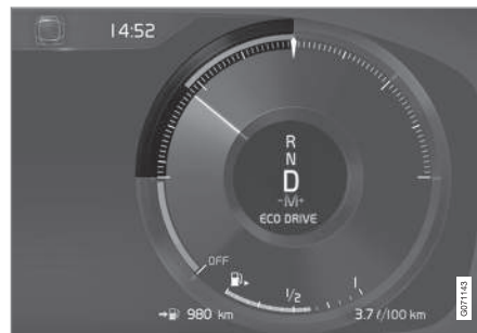
Misuratore ECO sul display del conducente da 12".
