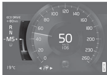
Misuratore ECO sul display del conducente da 8".
