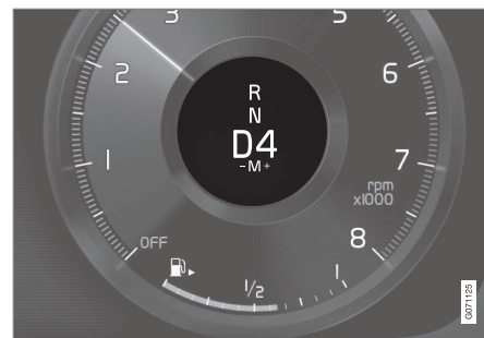
Display del conducente in caso di cambio marcia con le leve al volante e la leva selettoria piccola.
