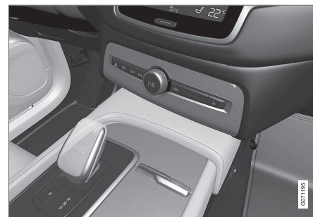
Panoramica della leva del cambio piccola dove non è possibile disattivare l'immobilizzatore della leva selettoria.
