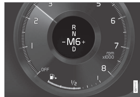
Panoramica dello schema di cambio sul display del conducente per la leva selettore piccola.
