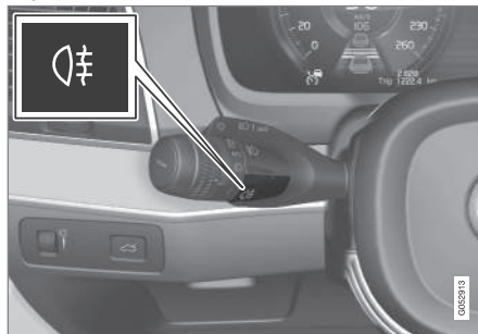
Bouton de feux arrière de brouillard.
