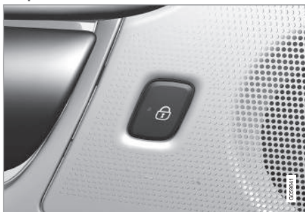
Bouton avec lampe indicatrice de verrouillage/déverrouillage de porte arrière.
