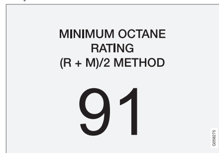
Illustration 1: exemple d'étiquette d'indice d'octane 16 sur une pompe à carburant.
