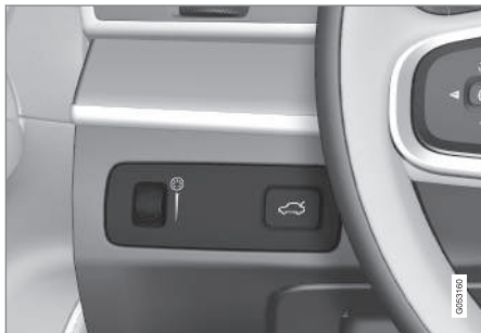
Molette (à gauche) pour ajuster la luminosité de l'habitacle
