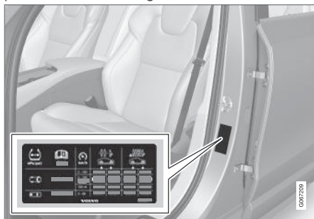
Emplacement de l'étiquette de pression des pneus
