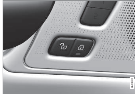
Botón de bloqueo y desbloqueo en la puerta delantera con luz de indicación.
