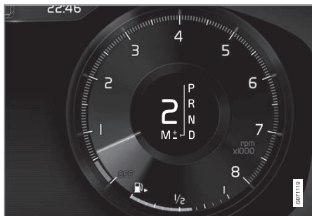
Pantalla del conductor al cambiar de marcha con las levas del volante en la posición de cambio manual, palanca de cambios grande.
