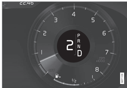
Pantalla del conductor al cambiar de marcha con las levas del volante, palanca de cambios grande.
