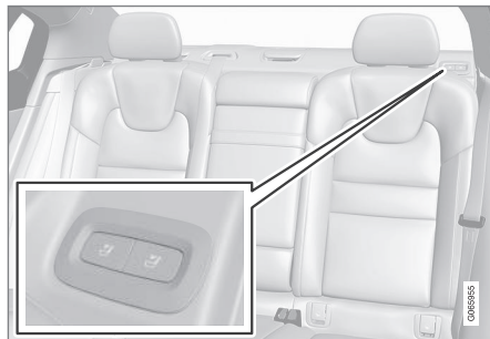
Botón de abatimiento de asiento, situado en la parte superior izquierda del asiento trasero.
