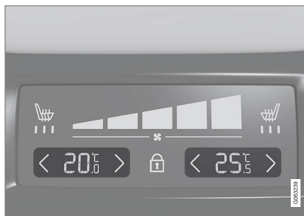
Control de temperatura en el panel de climatización de la consola del túnel.
