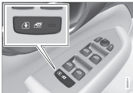
Botón de conexión y desconexión eléctrica.
