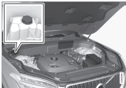
Depósito de expansión del sistema de refrigeración.
