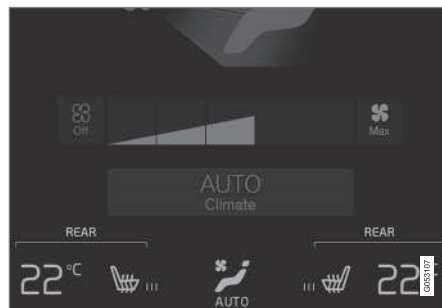
Botones de los asientos con calefacción eléctrica en el grupo Trasera de la vista de climatización.
