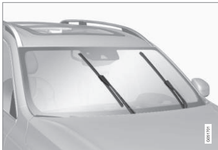
Escobillas de limpiaparabrisas en posición de servicio.
