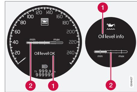
Mensaje y gráfico en la pantalla. La pantalla de la izquierda muestra el cuadro de instrumentos digital y la del lado derecho el cuadro de instrumentos analógico.
