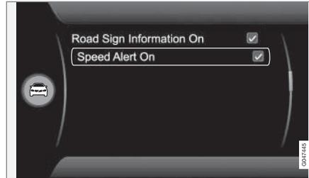
El conductor puede optar por recibir una advertencia en caso de rebasar el límite de velocidad vigente en 5 km/h (5 mph) o más. La advertencia se presenta a través del parpadeo temporal del símbolo con el límite de velocidad aplicable al superarse ésta. El sistema puede conectarse y desconectarse en el sistema de menús **MY CAR**. Para una descripción del sistema de menús, véase MY CAR (p. 120).
