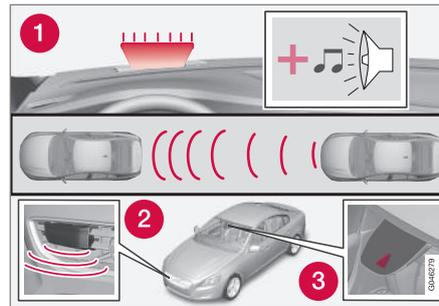
1. El testigo y la señal acústica del aviso de colisión<sup>6</sup>.
