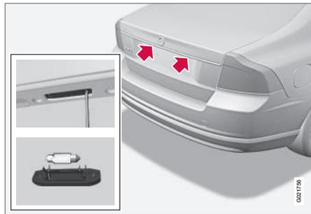
1. Suelte los tornillos con un destornillador.
