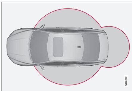
Los círculos rojos de la figura representan el radio de cobertura de las antenas del sistema.
