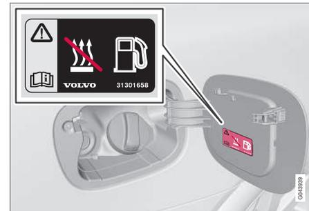
Cuando la temperatura exterior es elevada, puede producirse una ligera sobrepresión en el depósito. En este caso, abra la tapa lentamente.
