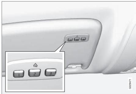
HomeLink®<sup>25</sup> es un mando a distancia programable que puede controlar hasta tres dispositivos diferentes (por ejemplo, la puerta del garaje, el sistema de alarma, la iluminación exterior e interior, etc.) y utilizarse por tanto en lugar de los mandos a distancia correspondientes.
