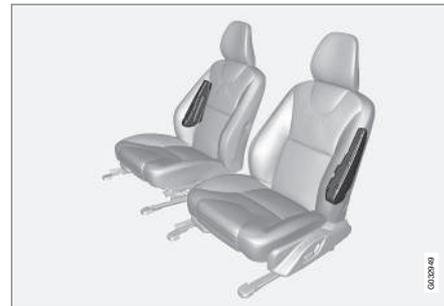
El sistema SIPS-bag consta de dos componentes principales, airbag lateral y sensores. El airbag lateral va colocado en el bastidor del respaldo del asiento delantero.
