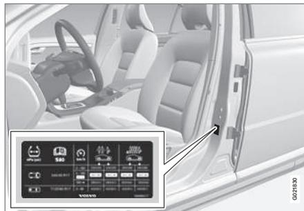
La placa de presión de neumáticos situada en el montante de la puerta del lado del conductor (entre la puerta delantera y la trasera) especifica la presión que deben tener los neumáticos en diferentes condiciones de carga y velocidad. Estos datos se indican también en la tabla de presiones de neumáticos, véase Neumáticos - presiones de inflado aprobadas (p. 415).
