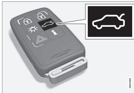
Con el botón
