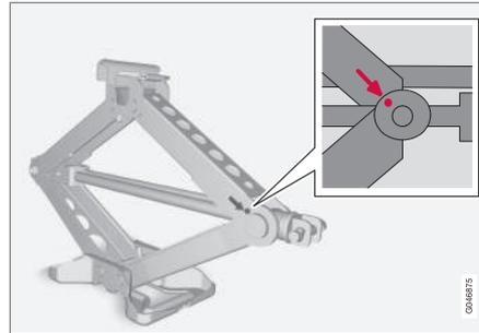
Cuando no se utilizan las herramientas o el gato\*, estos deben guardarse de manera correcta. El gato debe adaptarse a la posición correcta para tener sitio.
