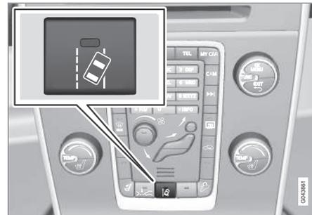
Pulse el botón de la consola central para conectar o desconectar la función. La luz del botón se enciende cuando la función está conectada.
