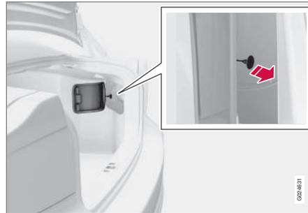
1. Abra o retire la tapa lateral en el maletero (en el mismo lado que la tapa del depósito) y busque un cable de color verde con palanca.
