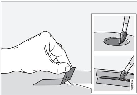
Antes de comenzar los trabajos, el automóvil debe estar limpio y seco y a una temperatura por encima de 15 °C.
