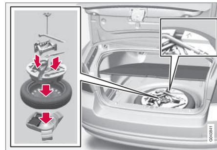
Debajo del piso del compartimento de carga se guardan la anilla de remolque, el gato\* y la llave para los tornillos de rueda\* del automóvil. Se incluye también aquí espacio para el manguito de los tornillos de seguridad de la rueda y herramientas para los capuchones de plástico de los tornillos de rueda.
