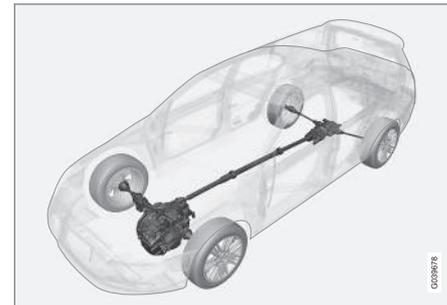
Con la tracción integral (All Wheel Drive), el vehículo avanza impulsado por las cuatro ruedas.
