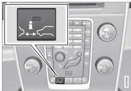
Pulse el botón de la consola central para conectar o desconectar la función. La luz del botón encendida indica que la función está conectada.
