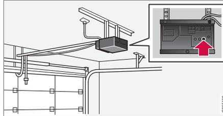
4. Busque el "botón de memorización<sup>26</sup>" en el receptor de, por ejemplo, la puerta del garaje, que suele estar situado cerca de la fijación de la antena en el receptor.
