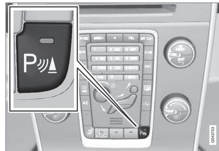
Conexión y desconexión del aparcamiento asistido.
