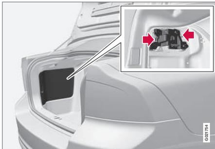
Las bombillas de las luces traseras se cambian desde el interior del maletero (excepto las bombillas LED).
