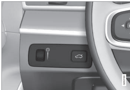
Rueda selectora (izquierda) para ajuste de la intensidad luminosa interior.
