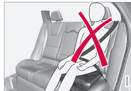
Pozycja nieprawidłowa – zagłówek trzeba ustawić na wysokości głowy, a taśma pasa bezpieczeństwa nie może spoczywać poniżej barku.
