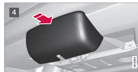
4 Nałożyć i docisnąć osłonę gniazda, aż zostanie ciasno osadzona.
