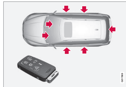
Zamki aktywne dla pilota zdalnego sterowania z kluczykiem mechanicznym.
