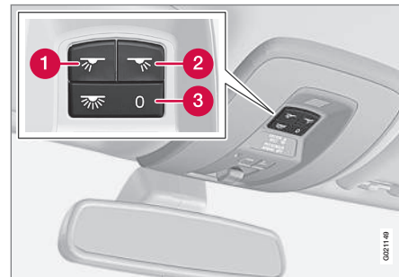
Górną konsolę sterowania z wyłącznikami oświetlenia kabiny i przednich lampek oświetlenia do czytania.
