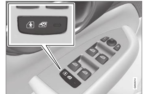
Botón de conexión y desconexión eléctrica.
