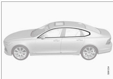
Alkatrészek, amelyek 3,5 és 11,5 pH-érték közötti tisztítószerekkel moshatók.
