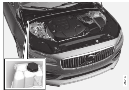
Hűtőfolyadék tágulási tartálya, balkormányos autó.
