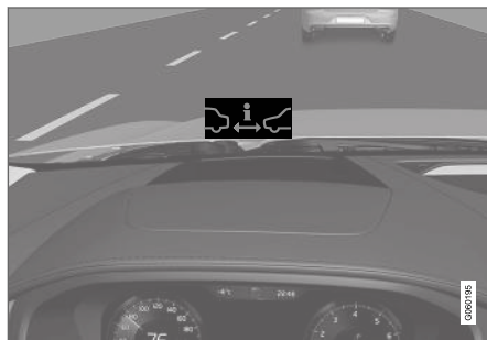
Távolságfigyelmeztetés szimbólum a szélvédőn szélvédőre vetített kijelzővel.
