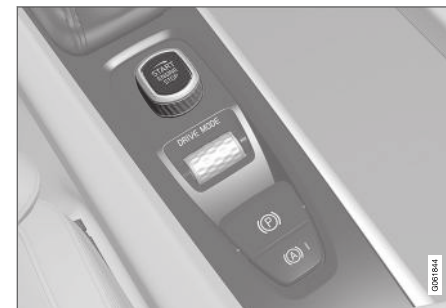
Indító gomb az alagútvezérlőn.
