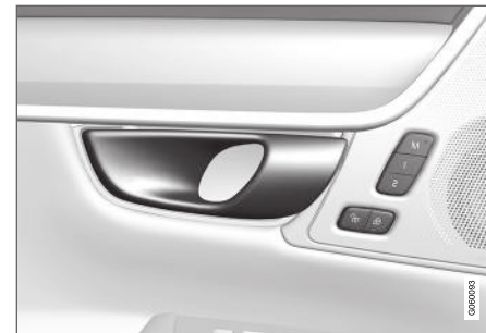
Nyitó fogantyú az oldalajtó alternatív nyitásához 12 .
