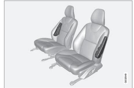
Le système SIPS se compose de deux parties principales : des coussins gonflables latéraux et des capteurs. Les coussins gonflables latéraux sont intégrés dans les cadres des dossiers des sièges avant.
