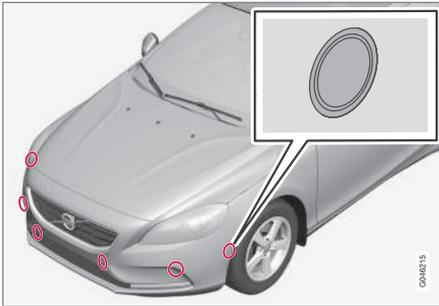
Les capteurs PAP se trouvent dans les pare-chocs<sup>34</sup> : 6 à l'avant et 4 à l'arrière.
