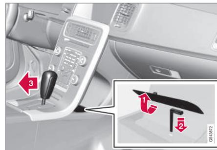
Si la voiture ne peut être conduite, par ex. lorsque la batterie est déchargée, il faudra sortir le sélecteur de vitesses de la position **P** pour pouvoir déplacer la voiture.
