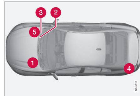
Emplacement des centrales sur une voiture avec conduite à gauche. Pour les voitures avec conduite à droite, les centrales se trouvent du côté de la boîte à gants.
