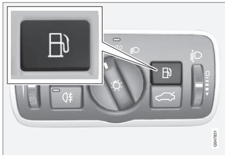
La trappe du réservoir de carburant est déverrouillée et ouverte grâce au bouton du panneau d'éclairage. La trappe s'ouvre lorsque vous relâchez le bouton.
