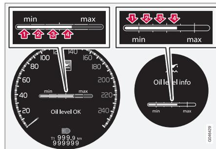
Les chiffres 1 à 4 représentent le niveau de remplissage. Ne rajoutez pas plus d'huile si le niveau de remplissage (3) ou (4) s'affiche. Le niveau de remplissage recommandé est de 4. Message et représentation graphique à l'écran. L'écran gau-
