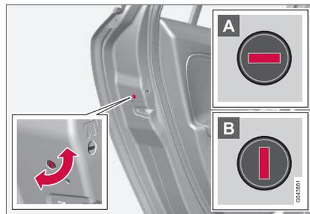
Verrouillage manuel d'une porte. À ne pas confondre avec le Verrouillage de sécurité enfant (p. 182).
