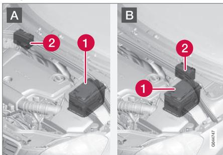
A : voiture à conduite à gauche. B : voiture à conduite à droite. (1) Batterie de démarrage<sup>16</sup> (2) Batterie d'appoint.
