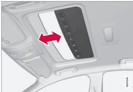
Une pression longue sur le bouton de verrouillage permet de fermer le toit ouvrant et toutes les vitres, référez-vous à Télécommande - fonctions (p. 163) et Verrouillage/déverrouillage - de l'intérieur (p. 177). Les portes et le coffre à bagages sont verrouillés. Si vous devez interrompre la fermeture, appuyez à nouveau sur le bouton de verrouillage.
