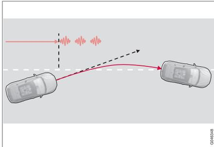
LKA intervient et avertit le conducteur par des vibrations au volant<sup>26</sup>.
