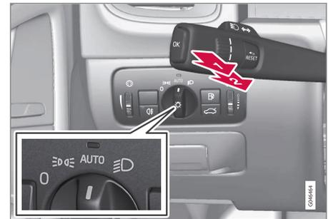
Levier au volant et bouton du commutateur d'éclairage.
