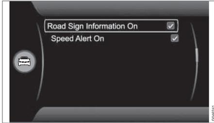
L'affichage des panneaux de limitation de vitesse sur le combiné d'instruments peut être désactivé. La fonction peut être activée/désactivée dans le système de menu **MY CAR**. Pour une description du système de menu, voir MY CAR (p. 111).
