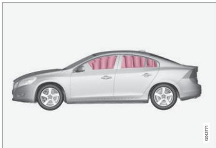
Le rideau gonflable IC (Inflatable Curtain) est un composant du système SIPS (p. 36) et du système de coussins gonflables (p. 32). Il est monté le long des deux côtés du plafond et aide à protéger le conducteur et les passagers assis sur les sièges extérieurs de la voiture. Lors d'une forte collision, les capteurs réagissent et le rideau gonflable se gonfle.
