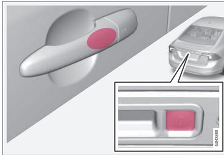
La zone tactile sur la poignée extérieure des portes et un bouton caoutchouté près du bouton gainé de caoutchouc du coffre à bagages.
