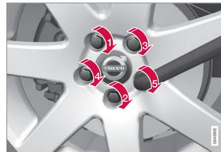
4. Serrez fermement les boulons de roue en croix et de manière alternée. Il est important que les boulons de roue soient correctement serrés. Serrez à 140 Nm. Vérifiez le couple de serrage des écrous à l'aide d'une clé dynamométrique.
