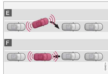
Après avoir reculé dans l'espace de stationnement, la voiture doit être correctement placée.
