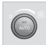
Tournez la molette pour augmenter ou réduire la vitesse du ventilateur. Si **AUTO** est sélectionné, la vitesse du ventilateur est régulée automatiquement (p. 133) - le réglage de la vitesse du ventilateur est annulé.
