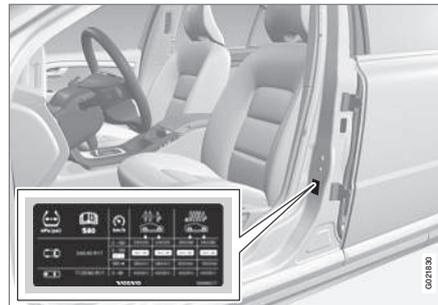
L'autocollant de pressions de pneu sur l'intérieur du montant de porte du côté conducteur (entre les portes avant et arrière) quelle pression les pneus doivent avoir à différentes conditions de charge et de vitesse. La pression correcte est aussi indiquée dans le tableau de pressions de pneu, référez-vous à Pneus - Pressions de pneus admises (p. 442).
