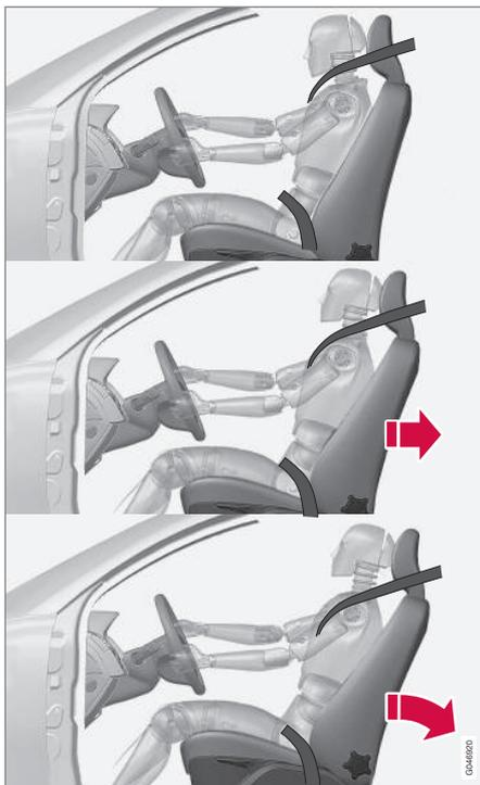
Le système WHIPS est activé en cas de collision par l'arrière en prenant en compte l'angle de la collision, la vitesse et les caractéristiques de l'autre véhicule.
