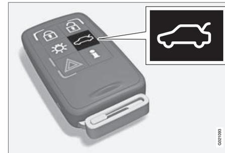
Grâce au bouton
