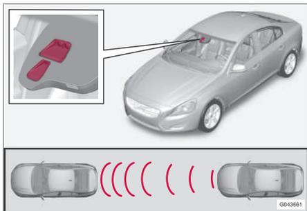
Fenêtre d'émission et de réception du capteur laser<sup>14</sup>.
