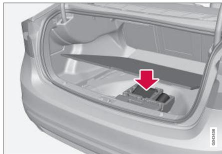
Sous le plancher du coffre à bagages se trouve l'œillet de remorquage, le cric\* et la clé à boulon de roue\*. Il y a également la place pour la douille des boulons de roue de blocage et des outils pour insérer les capuchons en plastique de boulons de roue.
