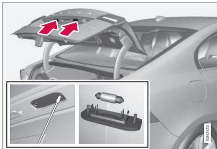
1. Desserrez les vis avec un tournevis.
