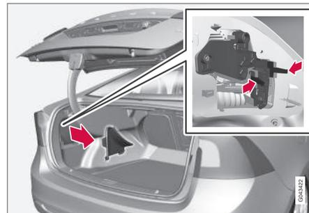
Les ampoules du combiné arrière se remplacent depuis le compartiment à bagages (pas les ampoules DEL).
