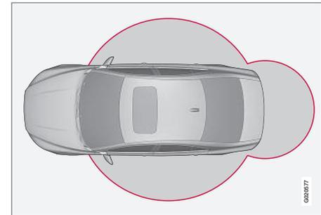
Les anneaux rouges de l'illustration ci-dessus indiquent les zones couvertes par les antennes du système.
