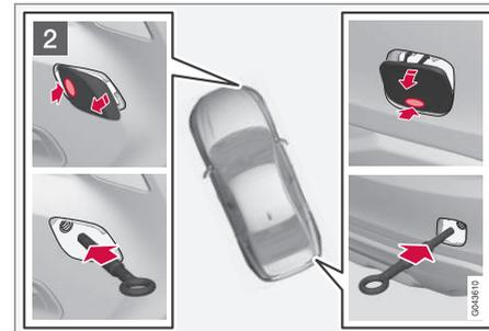
Dépose des caches avant et arrière.
