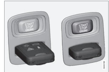
Contacteur d'allumage avec télécommande retirée/insérée.
