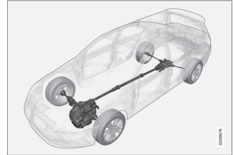
La transmission intégrale (All Wheel Drive) signifie que la voiture est entraînée simultanément par les quatre roues.
