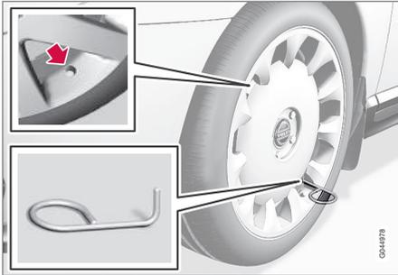
5. Vissez l'œillet de remorquage avec la clé à boulon de roue\* jusqu'en butée.
