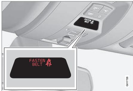
Le rappel sonore dépend de la vitesse et parfois du temps. Le rappel lumineux est situé dans la console du plafond et dans le combiné d'instruments (p. 62).
