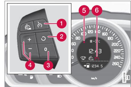
Clavier au volant et combiné d'instruments dans une voiture **avec** limiteur de vitesse<sup>4</sup>.
