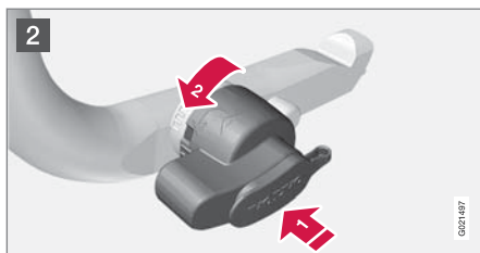
2 ロッキングホイール 1 を押し込み、カチッと音がするまで左に 2 回します。
