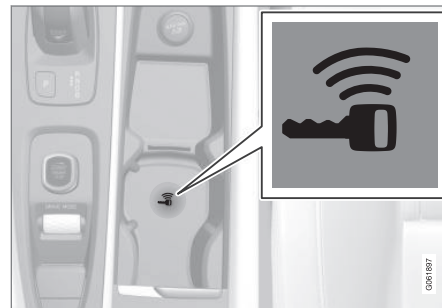
Backup-læserens placering i tunnelkonsollen.
