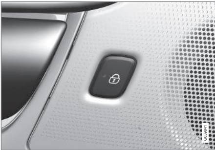
Låseknop med indikeringslampe i bagdør.
