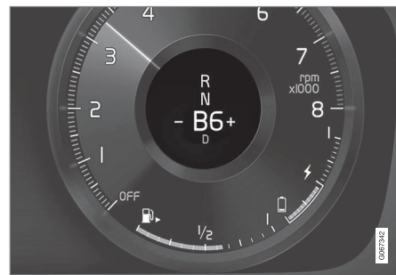
Gearskiftindikator på førerdisplayet 5 .
