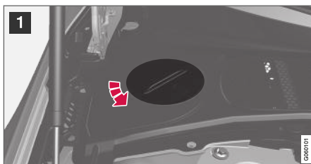
Vase d'expansion de liquide de refroidissement, véhicule avec direction à gauche.
