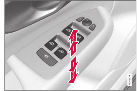
Fonctionnement des vitres électriques.
