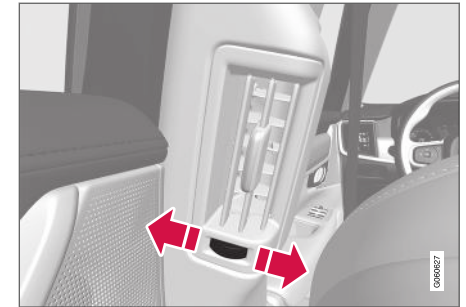
Molette de bouche de ventilation 2 .
