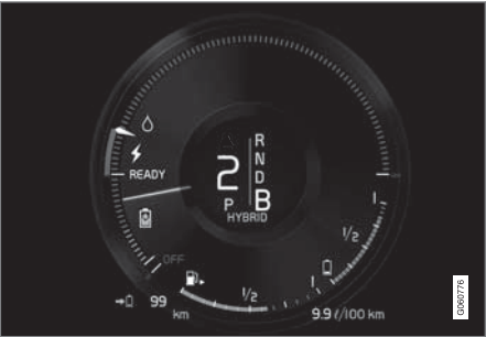
จอแสดงผลสำหรับคนขับจะแสดงการชาร์จในระหว่างการเบรกด้วยมอเตอร์ไฟฟ้า
