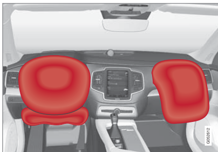
ถุงลมนิรภัยคนขับและถุงลมนิรภัยผู้โดยสาร
