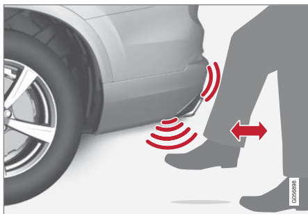
การเลื่อนเท้าโดยการเตะภายในบริเวณการสั่งงานของตัวตรวจจับ
