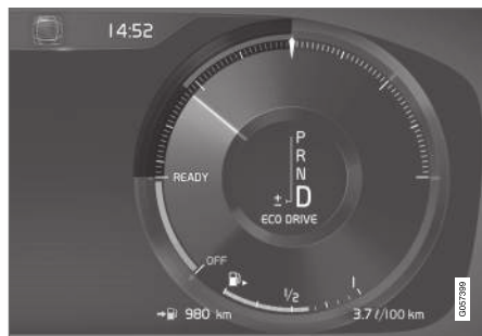
Medidor ECO no mostrador do condutor 12 polegadas*.
