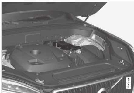
A bateria de apoio encontra-se numa caixa junto ao torreão da roda.
