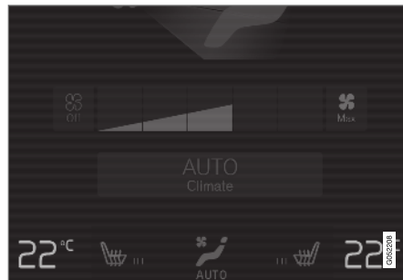
Botões de temperatura na linha da climatização.
