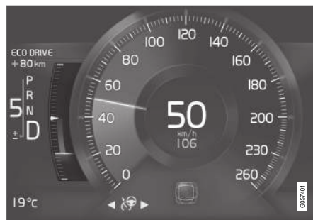
Medidor ECO no mostrador do condutor 8 polegadas.
