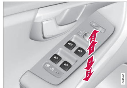
Bedieningsknoppen elektrisch bedienbare zijruiten.
