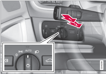
Stuurhendel en verlichtingsdraaiknop.
