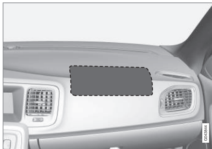
Placering av krockudde på passagerarsidan i vänsterstyrd bil.
