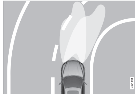
Lichtbundel bij gedeactiveerde (links) en geactiveerde (rechts) functie.
