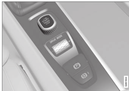
Startknappen i tunnelkonsollen.
