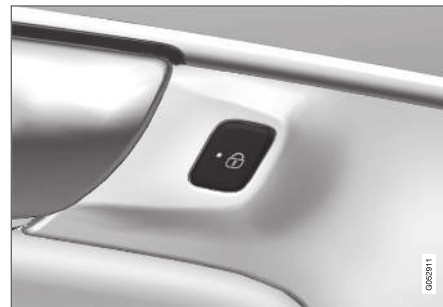
Knap til låsning i bagdør med indikeringslampe.
