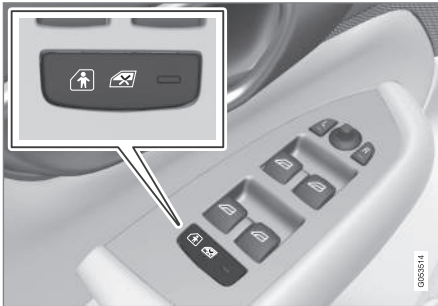
Botón de conexión y desconexión eléctrica.
