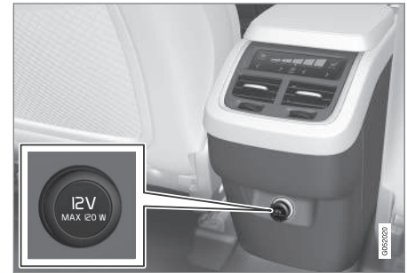
Toma de 12 V en la consola del túnel, segunda fila de asientos.
