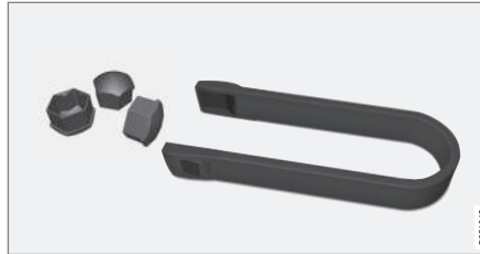
Herramienta para desmontar los capuchones de plástico de los tornillos de rueda.
