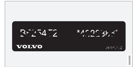
5 Etiqueta de código de motor y número de serie del motor.
