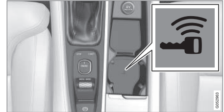
Ubicación del lector de seguridad en la consola del túnel.
